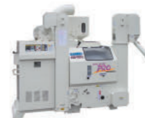
KMP551Z 返り粉粗選機付き ■最大処理量:2,160kg/h
